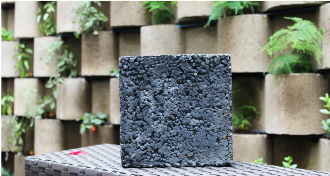
El **adocreto permeable Joben** esta elaborado con concreto a base de cantidades controladas de cemento, agregado grueso, agua y aditivos.
