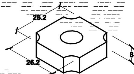
\* Tolerancias con respecto a las dimensiones reales de + 3mm son aceptadas por las normas NMX-C-36, NMX-C-37, NMX-C-38 y NMX-C-314
